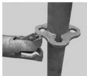
①クサビが収納された状態の手すりを支柱のフランジの真横から差し込みます。
