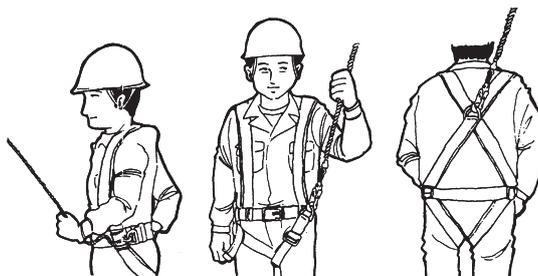
④引き寄せロープで安全フックを引き寄せ、安全フックを安全帯のD管に掛け、引き寄せロープを付けたまま鉄骨柱を昇降します。
