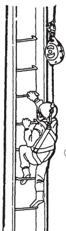
⑤安全フックが自動的に安全ブロックの本体に収納されますので、両手が全く自由な状態で昇降できます。
