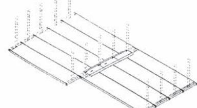
チェーンの回りのすき間をSKプレートで防護します。
