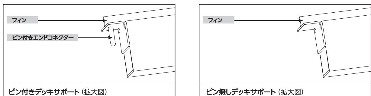
Finは、パネルを設置時に位置を合わせます。(ウッドデッキパネル、アルミデッキパネル)
