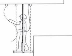
1枚目のSKパネルの上から前方約30cm位の所に各主桁下フランジ部に左右1ヶ所づつ、合計2本のチェーンを取り付けます。
