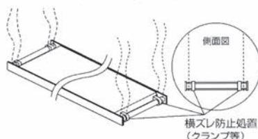
橋脚上から(または昇降設備がある場合はその最上段から)主桁等の吊りポイントに4本のチェーンクランプを設置し、チェーンを取り付けます。吊りポイントに取り付けられた4本のチェーンを1枚目のSKパネルの親フレーム両端内側にかけ、クランプ等で横ズレ防止処置を行います。
