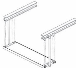
①の処置を行った1枚目のSKパネルを、静かに設置ポイントまでおろし、単管、クランプ等でフレ止め処置を行い、支持構造物と固定してください。
