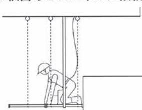
接続は2枚目のSKパネルの凹穴を1枚目のSKパネルの「直線・両用連結ジョイント」に差し込みます。次に「脱落防止ピン」を差し込み、「ジョイント固定ボルト」を締めつけなければ完了です。以上の作業はすべてSKパネルの上で行われ、作業員が身を乗り出すなどの危険はありません。
