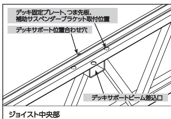
ジョイストはQuikDeck™の第一の構造構成部品です。ジョイストは連結ノードと連結して、デッキサポートおよびデッキ材のための格子を形成します。
