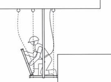
③で取り付けたチェーンを1枚目のパネル上で2枚目のパネルに取り付けます。
